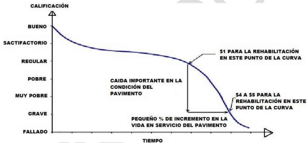
Figura 6-2-1. Condición del pavimento durante su vida útil
