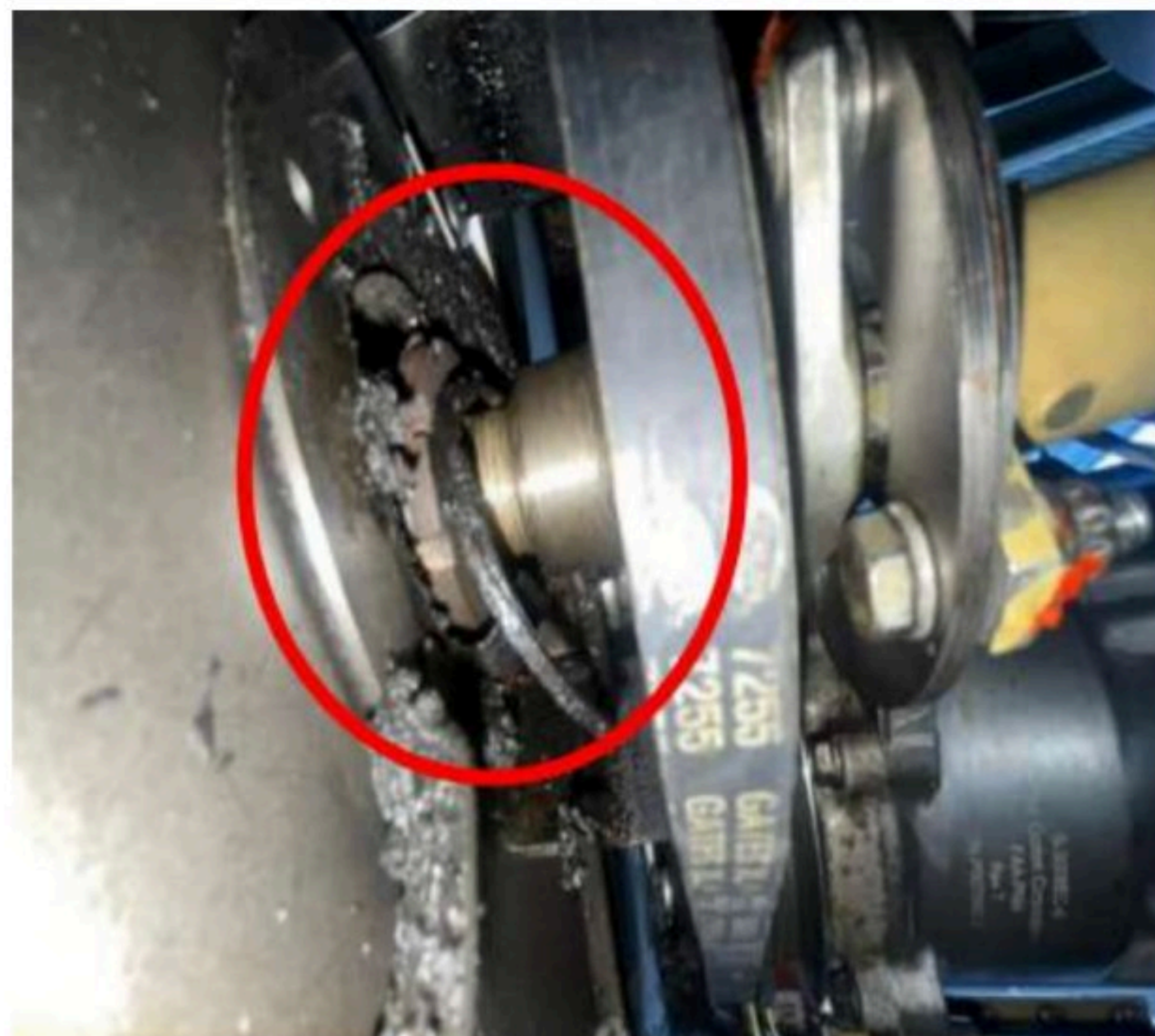
Figura 2: Rodamiento fracturado la cual fue la que causó el atascamiento de los pedales
