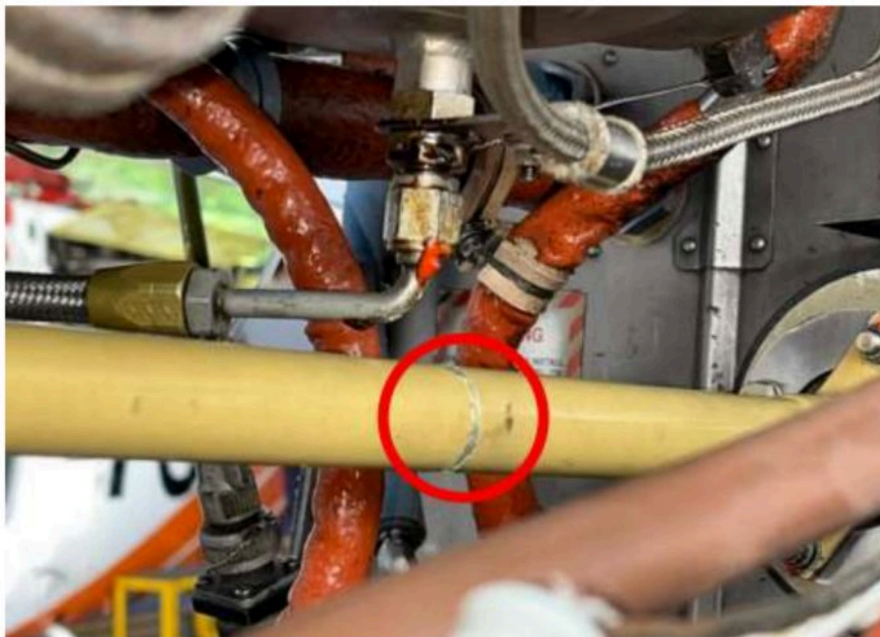
Figura 1: Eje afectado por el contacto con la línea de drenaje del motor
