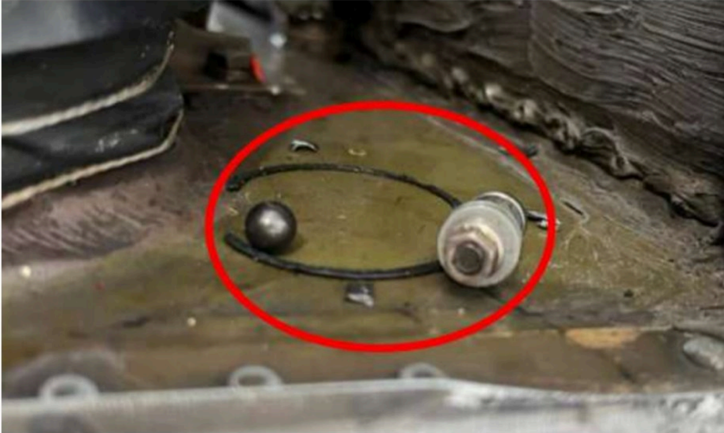
Figura 4: Un balín encontrado en el compartimiento del blower.
