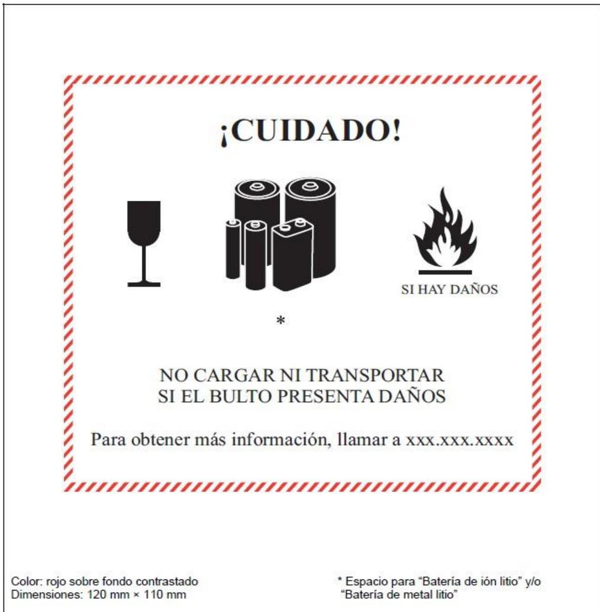
Figura 1.29. Etiqueta de manipulación de baterías de litio
