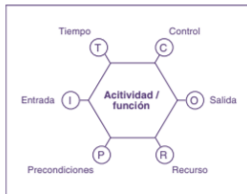
Ilustración 13. Parámetros básicos de cada función de un sistema. Fuente: Rubio & Bestatén (2018)
