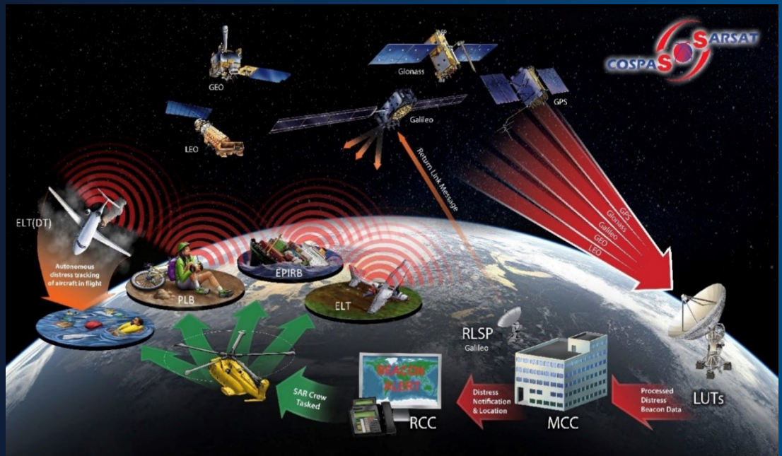
Figura 4 – Visión general del Sistema Cospas – Sarsat integrado con el servicio SAR/Galileo Fuente: http://www.cospas-sarsat.int/images/stories/SystemDocs/Current/SD48-DEC22--EN-.pdf
