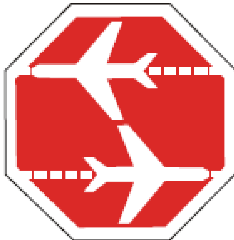
Figura 4-1-2 Señal de detención alternativa para puntos de espera de una vía de vehículos que intercepta una calle de rodaje. (Fuente: LAR 154 4ta edición 2023)
