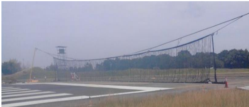
Figura 10-1 Barrera de frenado en operación (Fuente: FAC-JETIC 2020)
