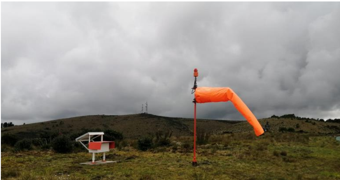
Imagen E1. Indicador de viento L-806
